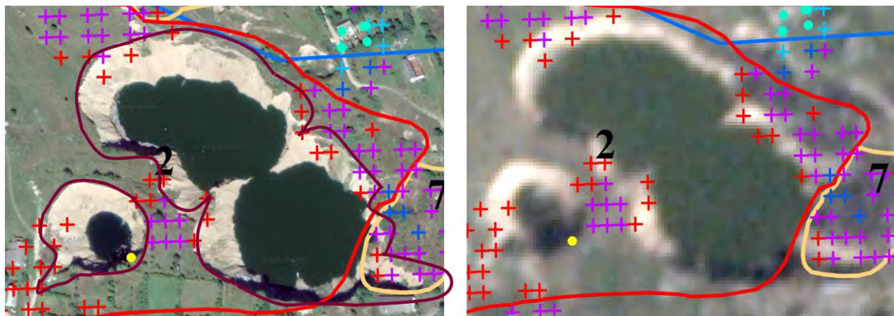
Рис.6. Космознімки південної частини куполу в районі провалів № 25 та № 25а у 2016 р. (зліва) та у 2018 р. (справа), які вказують на спостережувану динаміку до підняття рівня затоплення провалів та зростання рівня четвертинного водоносного горизонту
