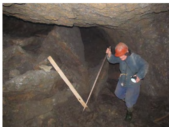
Рис. 6. Підшва порожнини над skleпінням стійкої рівноваги складена матеріалом від зруйнованих ціликів другого і першого горизонтів, міжгоризонтної стелі, водозахисної сетеліни та вміщуючих порід
