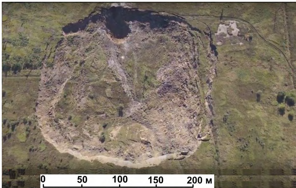
Рис. 9. Форма та розміри провалу що стався 30 вересня 2017 року на руднику № 2 Стебницького ГХП «Полімінерал» над ділянкою руйнування ціликів між камерами № 108-109-110-111-112-113 пласта № 10 ПД-Сх (зйомка з ДРОНа)
